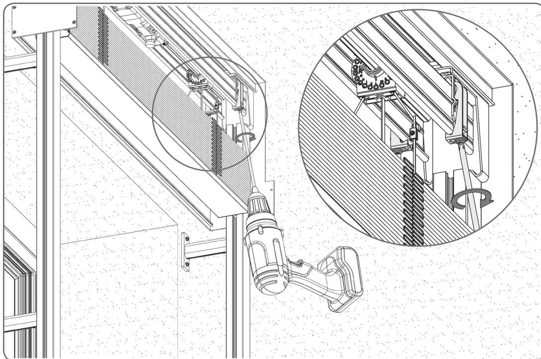
⚠ L'ensemble doit être centré avant la fixation des attaches.
