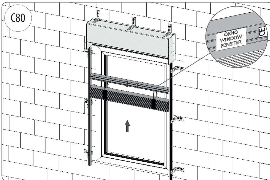
⚠ L'ensemble doit être installé de telle manière que l'autocollant „FENETRE” soit du côté de la fenêtre.
