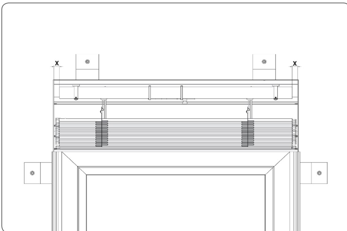
⚠ L'ensemble doit être centré avant la fixation des poignées.
