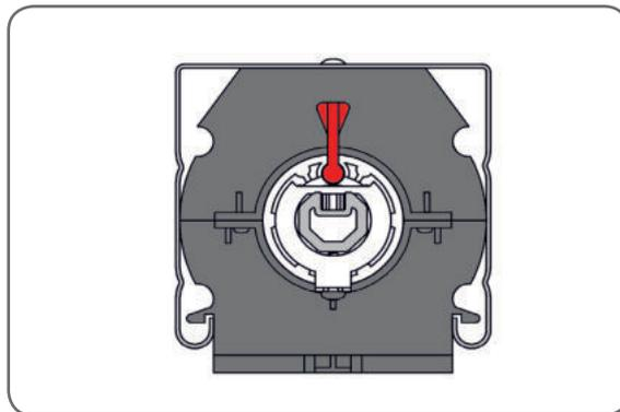
3. l'attelage inférieur n'est pas parfaitement horizontal, ajustez-le en changeant la position de l'axe du mécanisme auquel est attaché la corde la plus longue.
