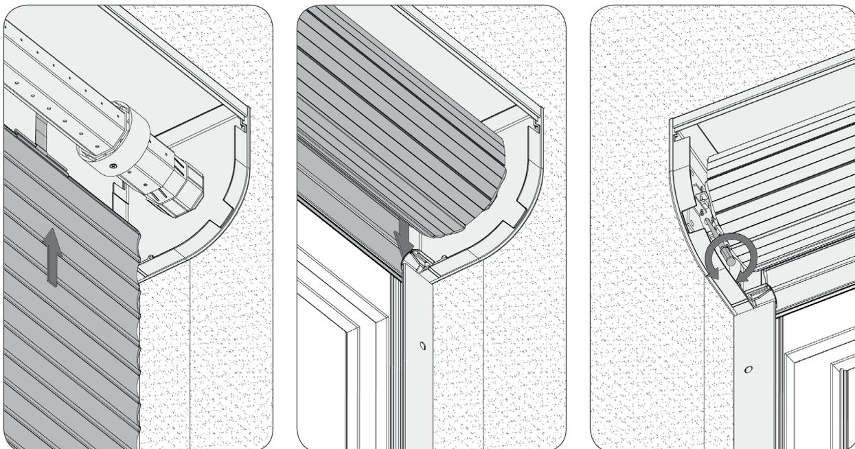
i) Vérifiez le fonctionnement. Fermez la boîte et insérez les bouchons.
