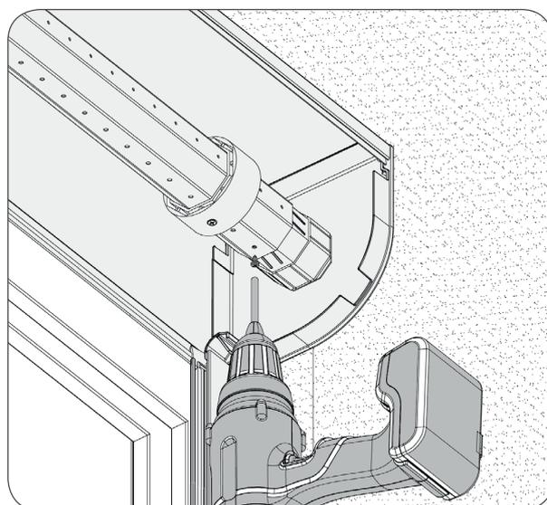
h) Enroulez le rideau, dans les canaux de guidage, insérez la lamelle d'extrémité et définissez les positions limites.
