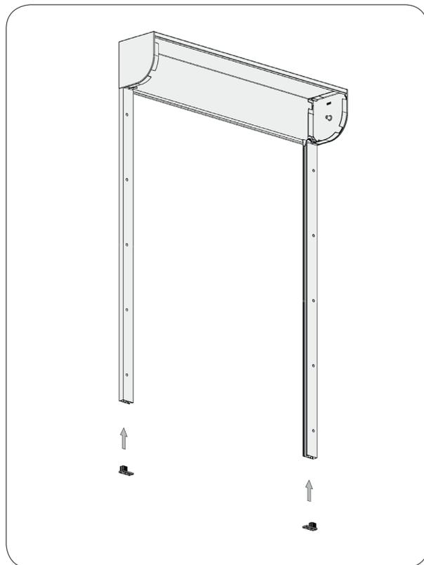
b) Apposer le rail de guidage et vérifier la perpendicularité.
