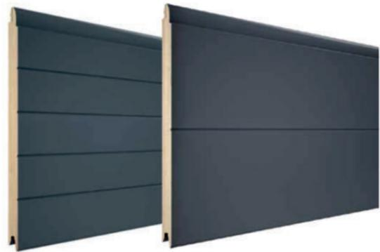
Le tablier est composé de panneaux de 40 mm d'épaisseurs remplies de mousse de polyuréthane. Les parois des panneaux sont en tôles en acier galvanisées à chaud avant d'être vernies. Large choix de couleurs, plaxages, laquages.
