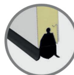
Joint d'étanchéité inférieure adjacente au sol.
