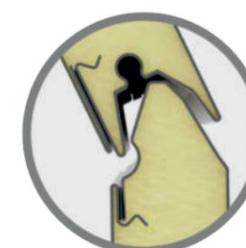
Les panneaux remplis de mousse en polyuréthane.
