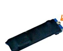
La touche de restauration des paramètres d'usine est située sous le connecteur. Appuyez pendant 10 secondes sur la touche pour restaurer les paramètres d'usine.
